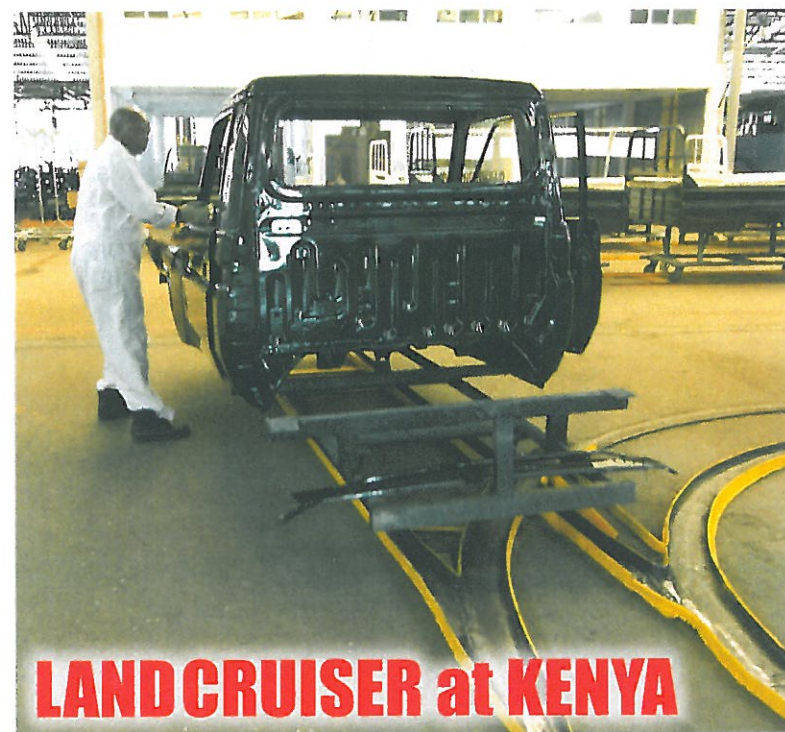
フロアパン、サイドパネルなどを手作りの治具で挟みスポット溶接でボディを組み立てていく。労働者の質、熟練度は高く、品質への心配はないという。
