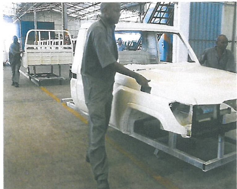
組立工場のシステム自由化率はほぼゼロ。ボディは労働者が手で押して内装ラインへと運ぶ。多品種少量生産のためマンパワーに頼る方が効率的だ。
