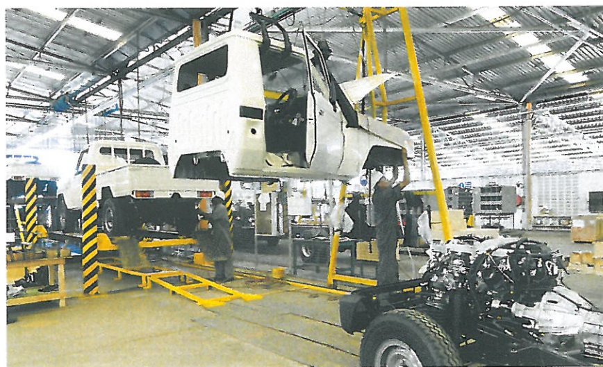
片手でリモコンを操作しクレーンに吊ったボディをシャシに下ろしていくが、1回で見事に合体させる。熟練のなせる技である。1時間に1台の割合で完成していく。
